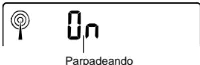
Se puede desactivar la función de recepción de hora DCF en aquellos lugares donde no es posible recibir la señal DCF. En este caso, el reloj funcionará como un reloj de cuarzo normal. (El ajuste por defecto es ON (función activada)).
