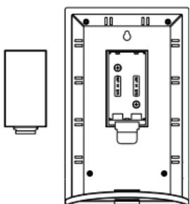
Метеорологическая станция работает с 2 батареями AA, IEC LR6, 1.5 В. Когда необходимо заменить батареи, появляется символ разряженной батареи на ЖК-экране. Для установки и замены батарей, выполните действия в следующей последовательности:
