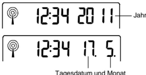
Die Voreinstellung des Datums der Wetterstation ist der 1.1.2011. Sobald das funkgesteuerte Zeitsignal empfangen wird, wird das Datum automatisch auf den aktuellen Stand gebracht. Wird kein Signal empfangen, kann das Datum auch manuell eingestellt werden.
