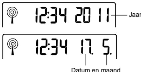
Het weerstation is standaard ingesteld op de datum 1. 1. van het jaar 2011. Zodra het radiografisch gestuurde tijdsignalen ontvangen is, wordt de datum vanzelf geactualiseerd. Wordt het signaal echter niet ontvangen, dan kan de datum ook met de hand worden ingesteld.
