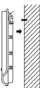
Väderstationen kan placeras stående på ett bord eller monteras på väggen. Innan du monterar enheten på väggen, kontrollera att utomhusdata kan tas emot från önskade platser.
