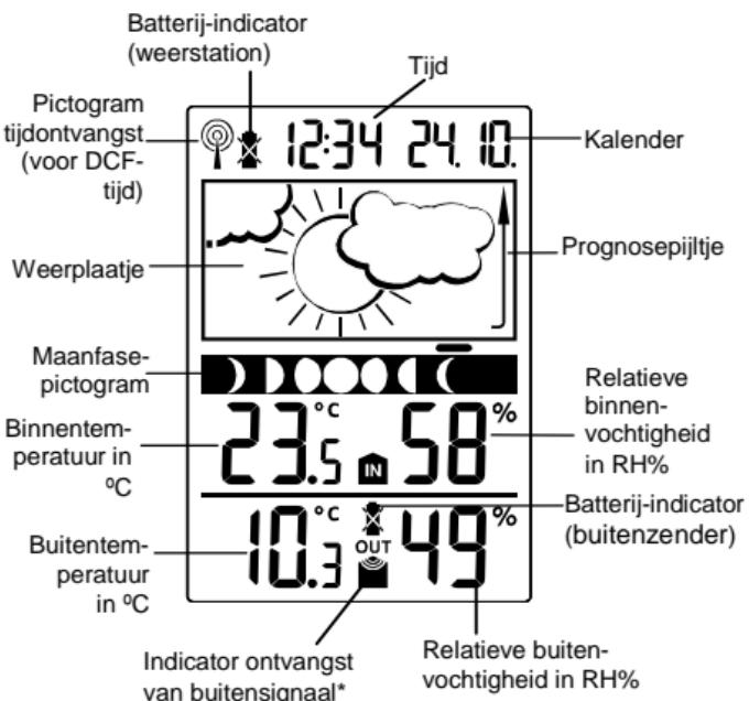
\* Als het weerstation erin geslaagd is het signaal te ontvangen, blijft het Symbool van signal buitenontvangst op het scherm staan (zoniet dan verdwijnt het). Er kan dus altijd worden afgelezen of ontvangst gelukt is (pictogram aan) of niet (pictogram uit).
