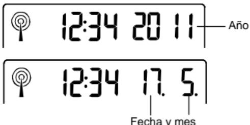
El ajuste de fecha por defecto de la estación meteorológica es 1. 1. del año 2011. Cuando se reciben señales horarias controladas por radio, la fecha se actualiza automáticamente. Sin embargo, si no se reciben estas señales, la fecha también puede ajustarse manualmente.
