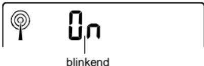
In Gegenden, in denen der Empfang des DCF-Zeitcodes nicht möglich ist, kann die DCF-Zeitempfangsfunktion abgeschaltet werden. Die Uhr arbeitet dann wie eine normale Quarzuhr (Voreinstellung ist EIN).
