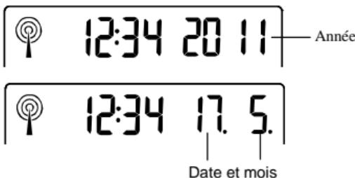
La date par défaut de la station météo est 1. 1. de l'année 2011. Dès que le signal radiocommandé est reçu, la date est mise à jour automatiquement. Si le signal n'est pas reçu cependant, la date peut également être programmée manuellement.
