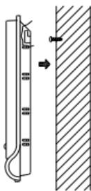
1. Необходимо закрепить винт в нужной стене, оставляя головку выдвинутой снаружи примерно на 5 мм.
