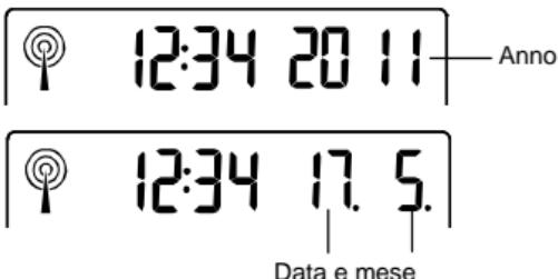
La data predefinita dalla stazione meteorologica è 1. 1. [1 gennaio] 2011. Una volta che i segnali del codice orario radiocontrollato sono ricevuti, la data è automaticamente aggiornata. Ad ogni modo, se i segnali del codice orario non sono ricevuti, è possibile regolare la data manualmente.
