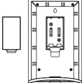
1. Öffnen Sie das Batteriefach, indem Sie den Daumen in die Aussparung drücken und den Batteriefachdeckel anheben.
