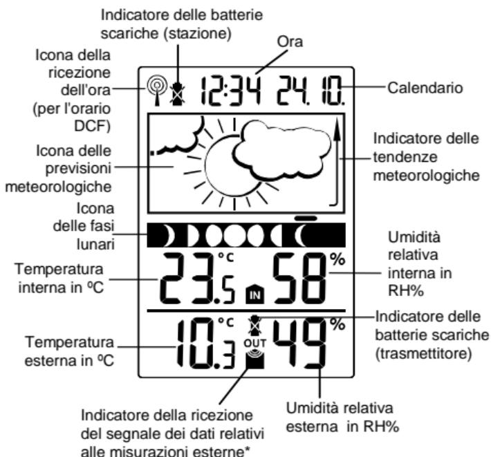
\* Quando il segnale proveniente dal sensore è ricevuto con successo dalla stazione meteorologica, si attiva l'icona della ricezione del segnale (se questo non avviene con successo, l'icona non si visualizza sul display a cristalli liquidi LCD). In questo modo l'utente può vedere facilmente se l'ultima ricezione è avvenuta con successo (icona attivata) o meno (icona disattivata).
