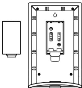
1. Introduzca un dedo u o otro objeto sólido en el espacio que hay en la parte inferior central del compartimiento de las pilas y levantar la tapa.
