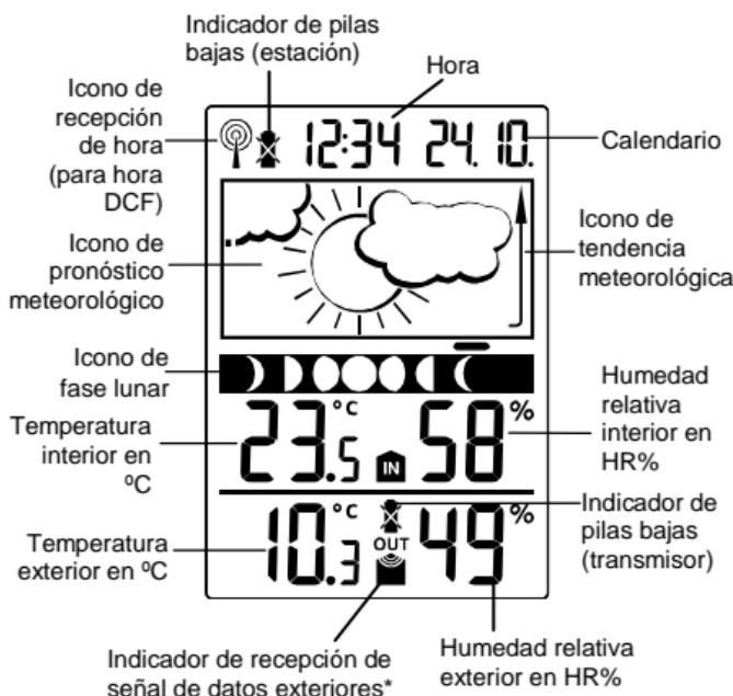
\* Cuando la señal sea recibida correctamente, el icono se encenderá. (Si la señal no se recibe correctamente el icono no aparecerá en la pantalla.) De manera que el usuario pueda ver fácilmente los datos de la última recepción exitosa de la señal (ícono encendido) ningún ícono (ícono apagado).
