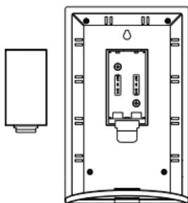
1. Steek een vinger of een stevig voorwerp in de ruimte midden onder bij het batterijvak en licht het deksel uit.
