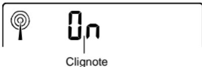
Dans les régions où la réception du signal DCF-77 est impossible, la fonction de réception du signal horaire peut être désactivée (OFF). L'horloge fonctionnera alors comme une horloge à quartz normale. (Le réglage par défaut est Activée (ON) ).
