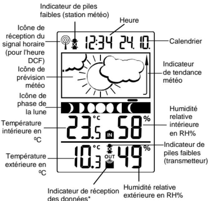
\* Lorsque le signal est réceptionné par la Station de Températures, l'indicateur de réception du signal extérieur reste affiché à l'écran (l'icône ne sera pas affichée si la réception échoue). L'utilisateur peut ainsi s'assurer de la bonne réception du signal (icône affichée) ou de l'échec de réception (icône absente).
