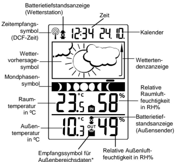
\* Wird das Signal von der Wetterstation erfolgreich empfangen, so ist das Symbol für die Außenbereichsdaten sichtbar (nicht sichtbar bei erfolglosem Empfang). Dadurch kann der Benutzer auch leicht erkennen, ob der letzte Empfangsversuch erfolgreich (Symbol Ein) oder erfolglos war (Symbol Aus).
