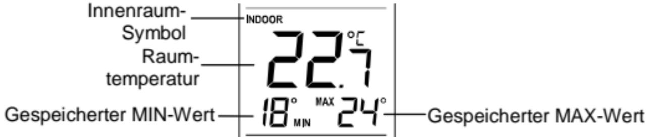
**Hinweis:** Der MIN/MAX-Raumtemperaturbereich reicht von -9,9°C bis +38°C mit 1°C Auflösung.
