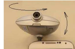
4. Dirija el sensor hacia la frente. ¡Tenga la precaución de una distancia del sensor desde 1 a 3cm! El tiempo de medición es de aprox. 1 segundo. Durante la medición no se debe cambiar la distancia del sensor hasta la piel.
