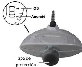
3. Conecte el instrumento al enchufe de auriculares del Smartphone y extraiga la tapa de protección.
