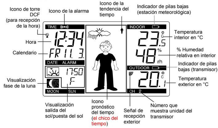
\* Cuando la señal sea recibida correctamente, el icono se encenderá. (Si la señal no se recibe correctamente el icono no aparecerá en la pantalla.) De esa manera el usuario puede ver fácilmente los datos de la última recepción exitosa de la señal (icono encendido) ningún icono (icono apagado) de otra manera, el icono pequeño que titila en la pantalla señala que ya se recibió la recepción.
