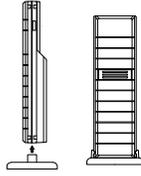
El transmisor exterior viene suministrado con un soporte que puede ser instalado en una pared con la ayuda de los dos tornillos incluidos. El transmisor exterior también puede ser colocado en cualquier superficie plana colocándole el soporte de montaje en la base, tal como lo muestra la figura.
