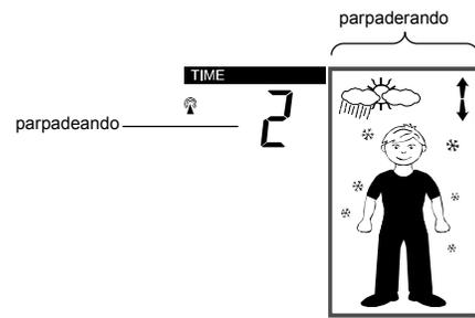
1. Pulse la tecla CH/ + para ajustar el nivel de sensibilidad de los pronósticos del tiempo. Hay 3 niveles para ajustar esta función 1, 2 y 3; el nivel 1 es el más sensible; el nivel 3 es el nivel menos sensible (viene preajustado en "2").
